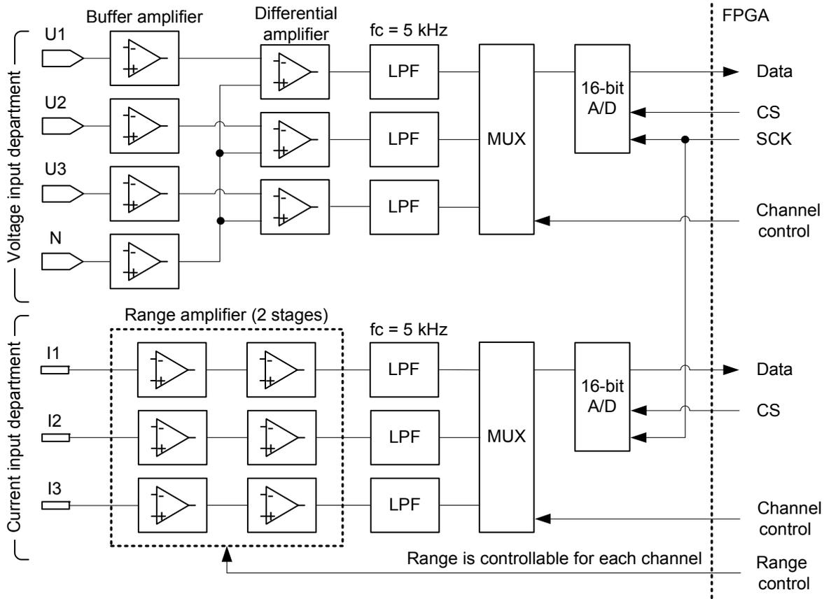
Fig. 9. Block Diagram (PW3365)
