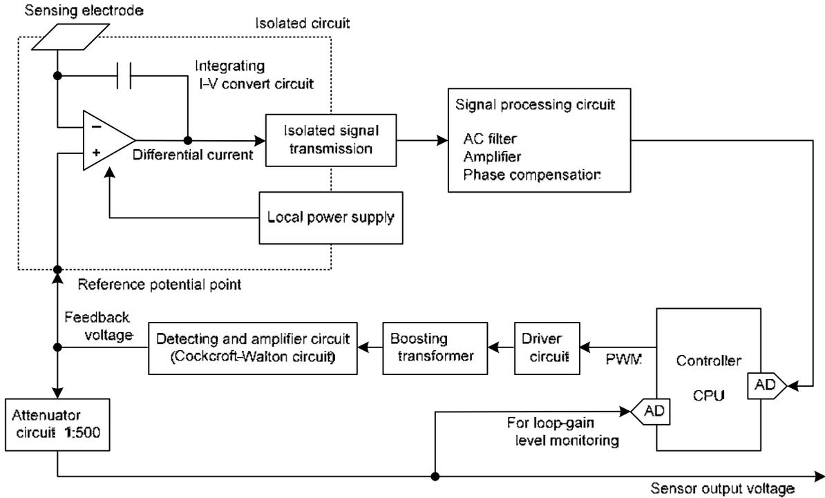
Fig. 2. Block Diagram (PW9020)
