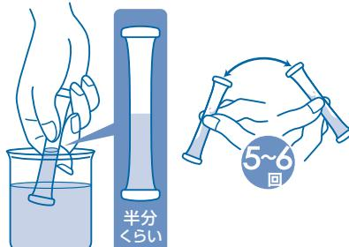
③そのまま穴を検水の中に入れ、つまんだ指をゆるめ、半分くらい水を吸い込むまで待ちます。液がもれないようにかるく5~6回振り混ぜます。
