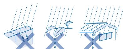
●採取の仕方……雨が降り出してから容器を設置して雨をためます。通常は雨がやんでから、たまたま雨水を測定しますが、別々に測定できるように降り始めとそれ以後別の容器に分けて雨を採取してもおもしろいでしょう。
